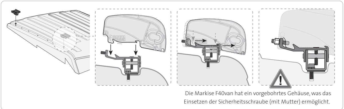
Die Markise F40van hat ein vorgebohrtes Gehäuse, was das Einsetzen der Sicherheitsschraube (mit Mutter) ermöglicht.
