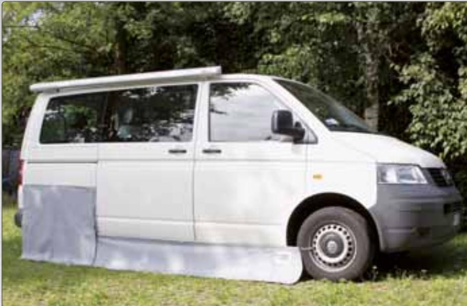
**DE** Windblende, welche vor Zugluft unter dem Fahrzeug schützt.
