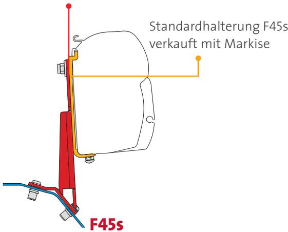
Spezialhalterung, speziell für Kit Ford Custom Lift Roof
