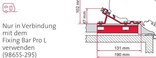
Nur in Verbindung mit dem Fixing Bar Pro L verwenden (98655-295)
