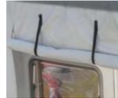
Klettverschluss zur Befestigung der Seitenwände bei vollständiger Öffnung
