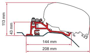
Halterung erforderlich, wenn das Fahrzeug mit einem zum öffnenden Panoramafrontdach ausgestattet ist
