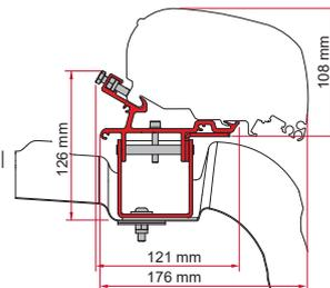
Auf VW Crafter L3/H3 wird die Markise F80s 320 cm Länge montiert
