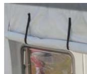
Velcro per fissare i pannelli laterali quando sono totalmente aperti
