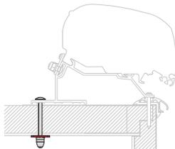
Kit composé de 4 plaquettes, vis et écrous rendant possible l'installation du store F80s sur les caravanes LMC à l'aide de l'Adaptateur ou Kit Caravan Roof
