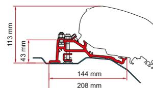
Adaptateur nécessaire en cas de véhicule équipé avec lanterneau panoramique couvercle frontal ouvrable
